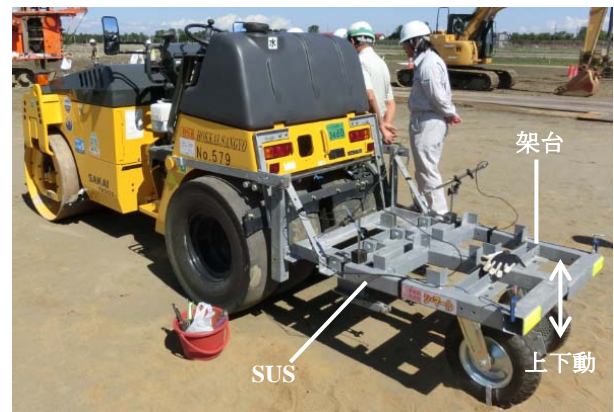
図-1 締め固め測定機
